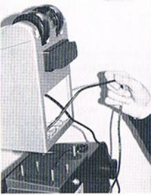
Stecken Sie das untere Teilstück auf das Motorgehäuse. Dazu müssen die Gewindestangen durch die Löcher des Teilstücks geschoben werden. Ziehen Sie das Kabel vom Motorgehäuse während des Verbindens heraus. Dieser Vorgang spannt das Kabel, damit es nicht eingeklemmt wird.
