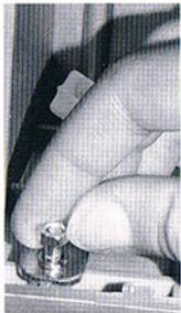
Stecken Sie die vier Unterlegscheiben und dann die Muttern auf alle Gewindestangen und drehen diese mit dem beiliegenden Maulschlüssel fest.
