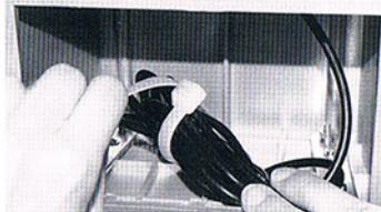
Damit das überschüssige Kabel im Gerät sicher befestigt wird, wickeln Sie es auf, und befestigen es mit dem Kabelbinder im Gerät.
